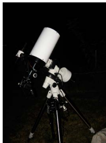
De opstelling van de 150 mm Ritchey-Chrétien waarmee de foto's van de behandelde objecten werden gemaakt..
